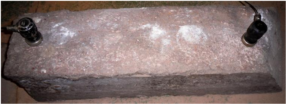
Рис. 2. Варіант поверхневого прозвучування датчиками з плоскою контактною поверхнею і затверділим контактним шаром.
