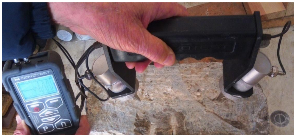
Рис. 3. Використання портативної апаратури Новотест ІПСМ для поверхневого прозвучування породних зразків.
