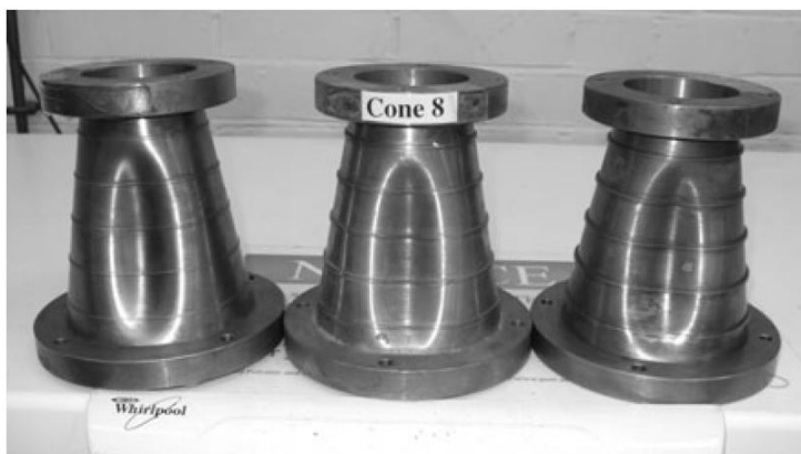
Рис. 4. Результати досліджень деформації дослідних зразків конічних оболонок з підсиленням твірної кільцевими елементами [10]
