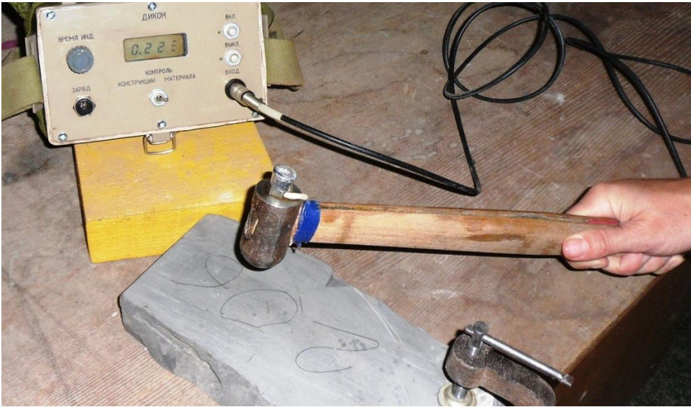
Рис. 4. Неруйнівна оцінка міцності порід з використанням авторського варіанту методу ударного імпульсу.
