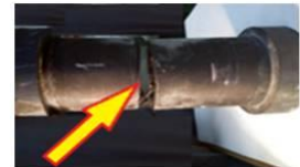
Вид руйнування оболонкової моделі РДТП
