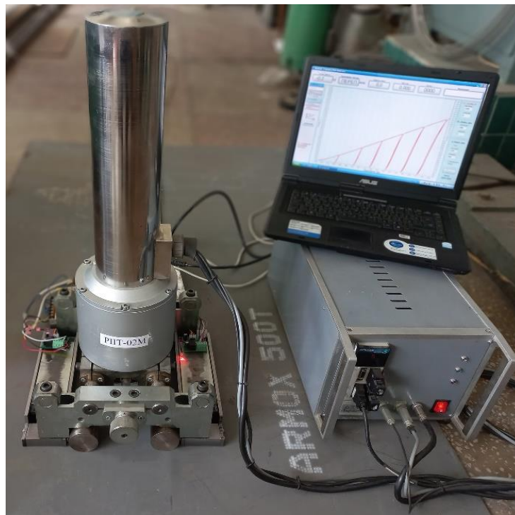
Рис. 2.4 – Переносна установка РІТ-02М з електромагнітним кріпленням при вхідній атестації листового прокату з високоміцної сталі Армох 500Т.
